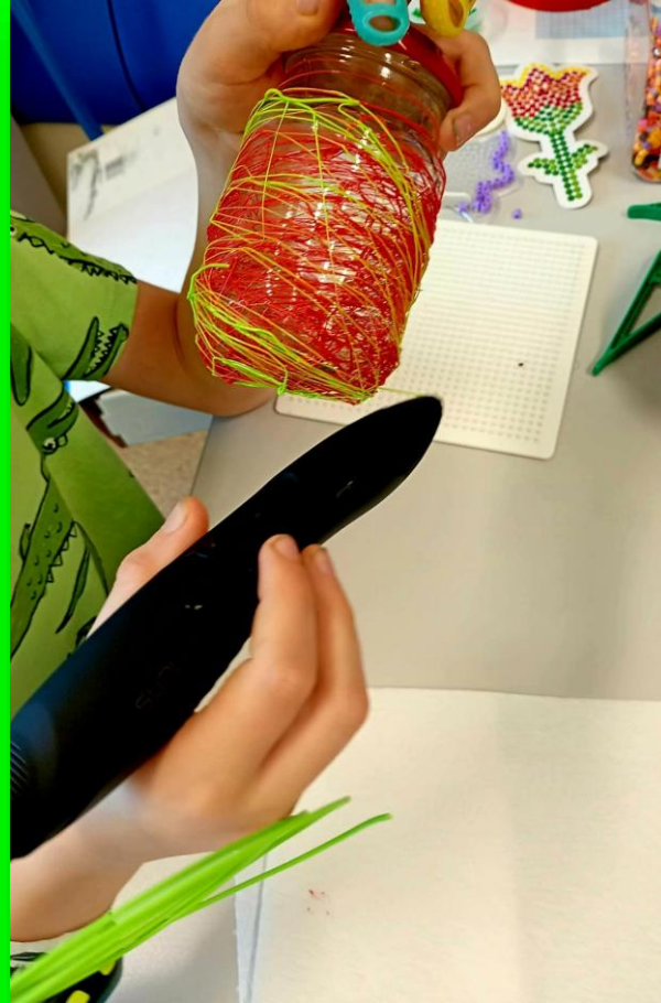
Wykonywanie walcowatego kształtu poprzez umieszczanie filamentu na obwodzie słoika stanowiącego formę.
