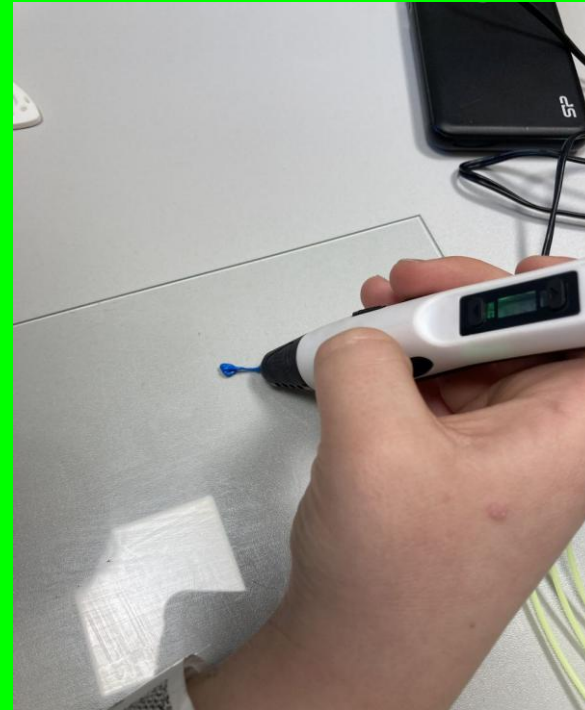
Usuwać resztki starego materiału, aż pojawi się płynny filament w wybranej barwie
